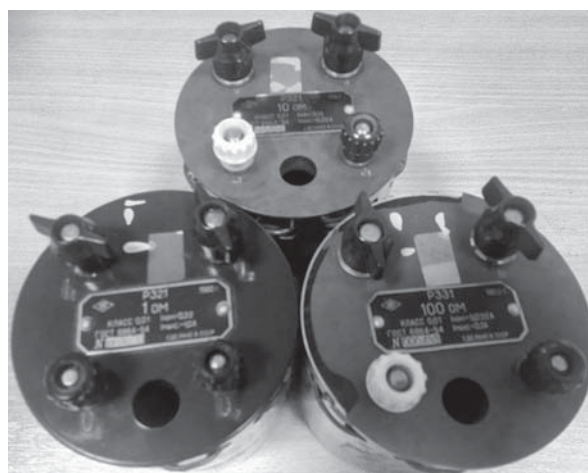
Рис. 1. Зовнішній вид мір електричного опору P321 (1 Ом), P321 (10 Ом) і P331 (100 Ом) Fig. 1. The general view of the measures of electrical resistance P321 (1 Ом), P321 (10 Ом) and P331 (100 Ом)
